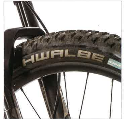
Ibis fut la marque qui initia la tendance de l'élargissement de la section interne des jantes, en partant du constat que l'élargissement des sections de pneus l'exigeait pour une bonne tenue du pneu. La largeur est ici de 34mm pour les pneus de 2.6 maximum.
